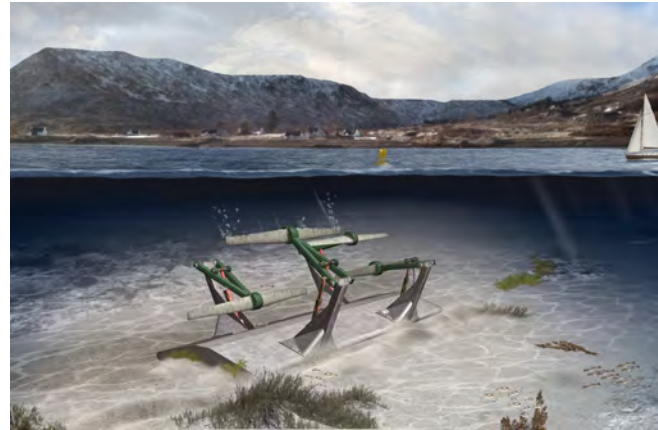
Fig. 5.6 - Pulse Tidal 1.2MW Horizontal Axis TSD
