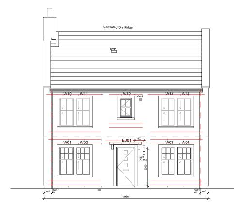
FRONT ELEVATION - Plot 29 Scale: 1:100
